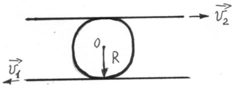
1. Цилиндр радиуса  $R = 2$  см зажат между двумя горизонтальными поверхностями, которые движутся в разные стороны со скоростями  $v_2 = 4$  м/с и  $v_1 = 3$  м/с. Найти угловую скорость вращения  $\omega$  цилиндра вокруг своей оси  $O$ , если он не проскальзывает относительно поверхностей. (4 балла)
