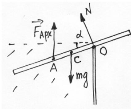
Так как палочка погружена на 60%, то длина отрезка  $OC = 0,1L$ , а отрезка  $OA = 0,3L$ . Напишем уравнение станики для моментов сил:
