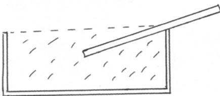
7. Тонкая палочка с однородным сечением лежит в равновесии на краю гладкого сосуда, доверху наполненного водой, причем 60% длины палочки погружено в воду. Чему равна плотность материала палочки? Плотностью воздуха пренебречь. (5 баллов)
