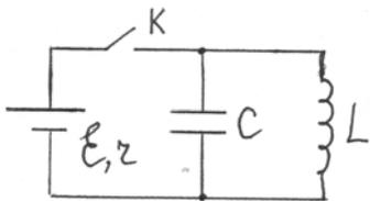
9. В схеме, показанной на рисунке  $C = 2 \cdot 10^{-12} \text{ Ф}$ ,  $L = 2 \text{ Гн}$ , ЭДС источника тока  $E = 200 \text{ В}$ , его внутреннее сопротивление  $r = 2 \text{ Ом}$ . В начальный момент времени  $t = 0$  ключ К размыкают. Найти величину
