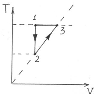
4. Два моля азота совершают процессы 1-2-3, изображенные на диаграмме. Какое суммарное тепло  $Q_{123}$  (алгебраическая сумма) получает газ за время этих процессов, если при этом его температура меняется на  $\Delta T = 100$  К. Универсальная газовая постоянная  $R = 8,31$  Дж/(моль\*К) (4 балла)
