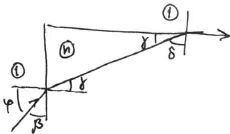
Луч перестает проходить сквозь призму потому, что он испытывает полное внутреннее отражение под углом  $\delta$  на второй поверхности при выходе из призмы:
